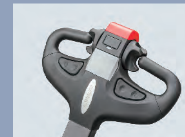
Łatwa w obsłudze modułowa kierownica pozwala na sterowanie wózkiem jedną ręką, a jej konstrukcja umożliwia wymianę każdego podzespołu oddzielnie
