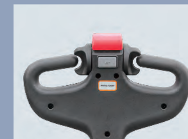
Duży kąt pracy dyszla ułatwia operowanie w ciasnych miejscach takich jak np. kontener
